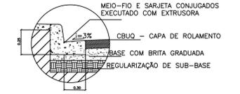
DETALHE 01 - MEIO-FIO/SARJETA CONJUGADOS PAVIMENTAÇÃO ASFÁLTICA - A SER EXECUTADO PELO CONTRATADO
