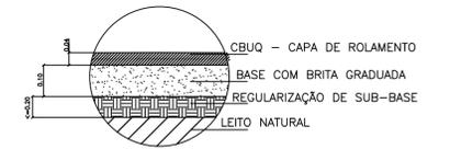
DETALHE 02 - PAVIMENTAÇÃO ASFÁLTICA
