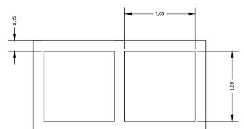
Reservatório de Água com Resíduos, feito em alvenaria com vedação.
